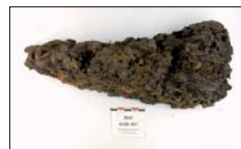
Fig. 7: Petit bloc scorie de Kobo. Ces blocs se formaient dans la base du bas fourneau.
