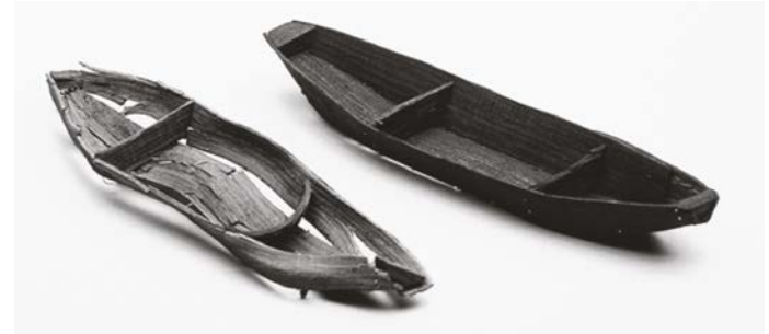
Bootsmodelle aus archäologischem wassergelagertem Holz; links nach der unkontrollierten Trocknung, rechts nach der Konservierung mit Polyethylenglycol (aus Hoffmann, 2013, 26)
