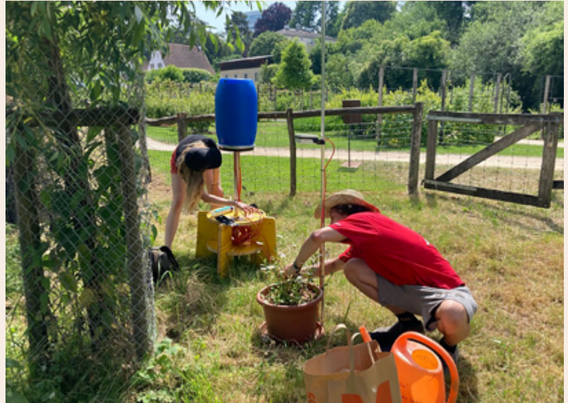
Aufbau eines Sensor-Ensembles mit Lockpflanzen, Kameras und digitalem Netzwerk-Knoten zum Monitoring von Insekten mittels Machine Learning im Kontext von Bestäubungsprozessen.
